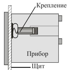
*Примечание. Возможен вариант исполнения корпуса Рис. 2 – Установка прибора прибора с креплениями, расположеннымными сверху и снизу, а не справа и слева.*
