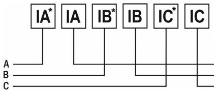
Рис. 7 – Подключение тока напрямую до 5 А
