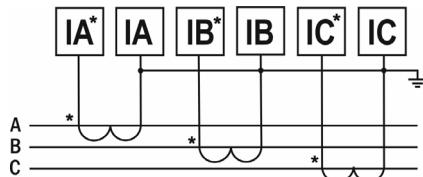
Рис. 8 – Подключение трансформатора тока х/5 А
