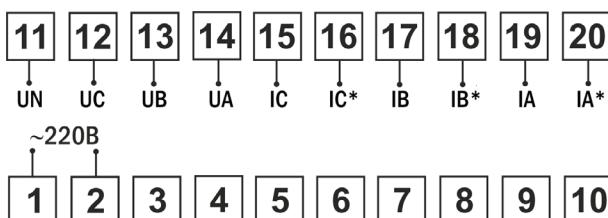
Рис. 4 – Клеммы подключения
