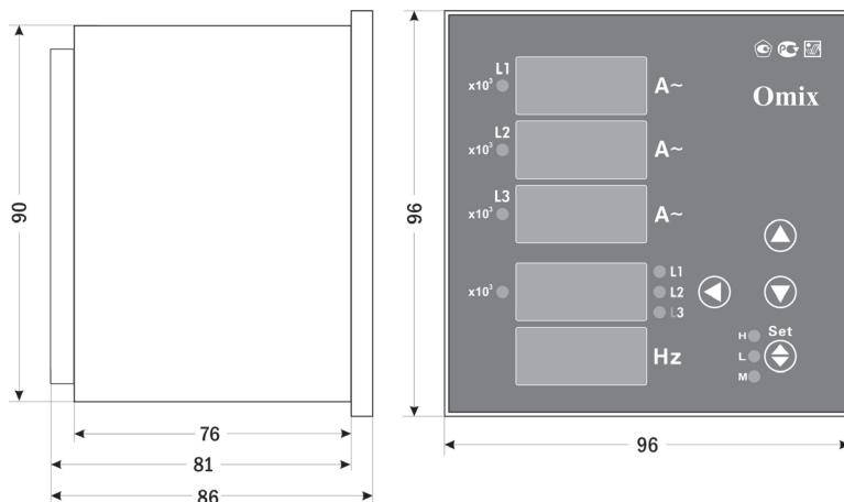
Рис. 3 – Размеры прибора
