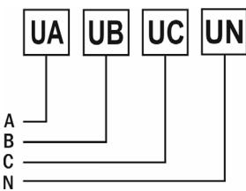
Рис. 5 – Подключение напряжения напрямую до 500 В
