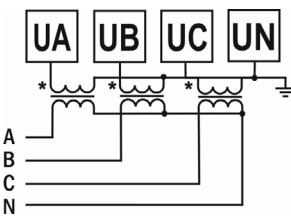
Рис. 6 – Подключение трансформатора напряжения х/500 В
