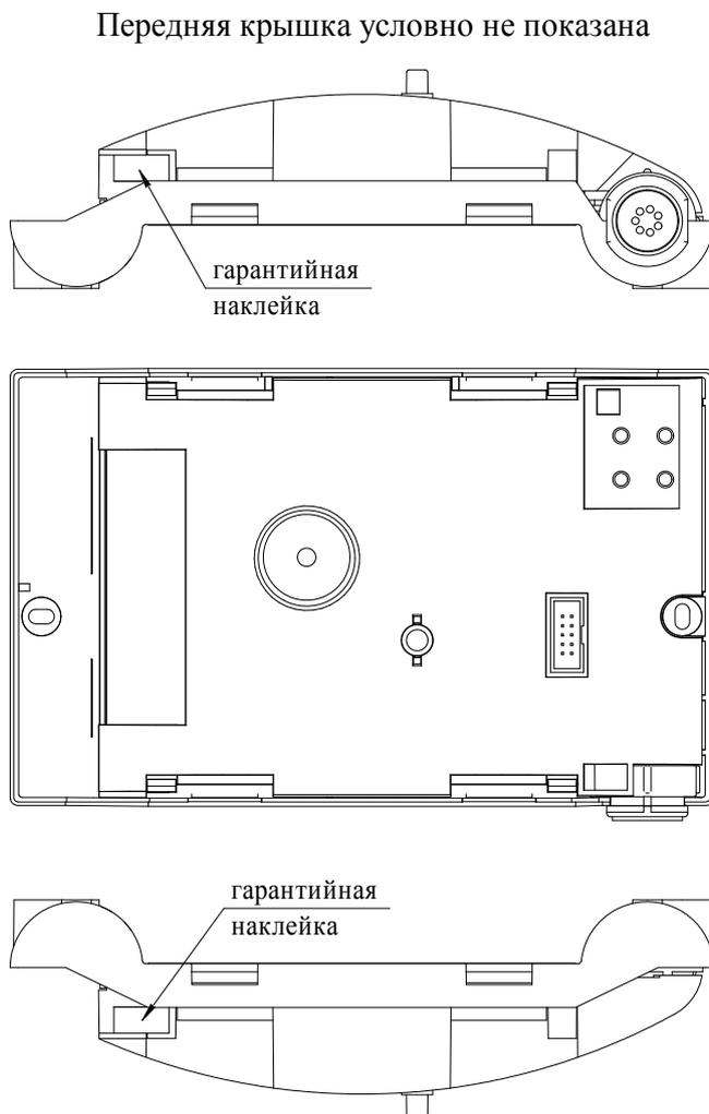
Рисунок А.1 - Схема пломбировки сигнализатора от несанкционированного доступа
