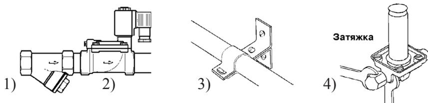
1) Перед монтажом клапана трубопроводы должны быть прочищены, так как попадание в клапан инородных частиц может привести к выходу его из строя. Перед входным отверстием соленоидного клапана необходимо установить фильтр-грязевик.
