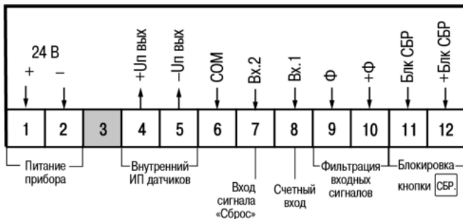
Рисунок 5.1 – Назначение контактов клеммника
