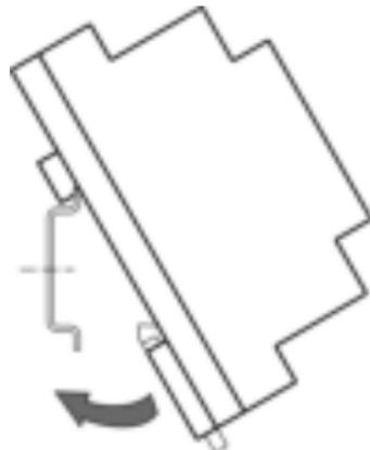
**Рисунок 4.9 – Монтаж прибора с креплением на DIN-рейку**
