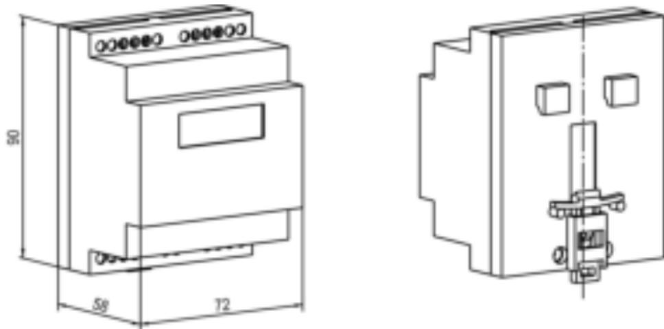
Рисунок 4.10 – Габаритные размеры корпуса Д
