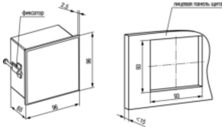
Рисунок 4.4 – Габаритные размеры корпуса Щ1
