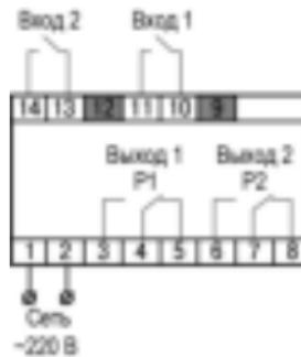
**Рисунок 5.2 – Общая схема подключения УТ1-Д**
