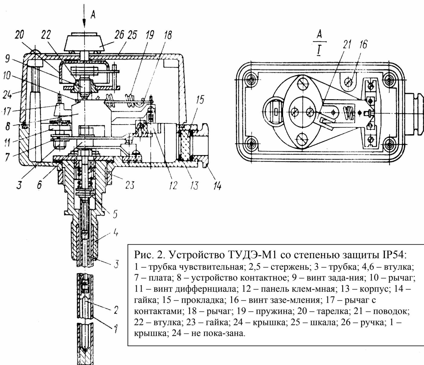
Рис. 2. Устройство ТУДЭ-М1 со степенью защиты IP54:
