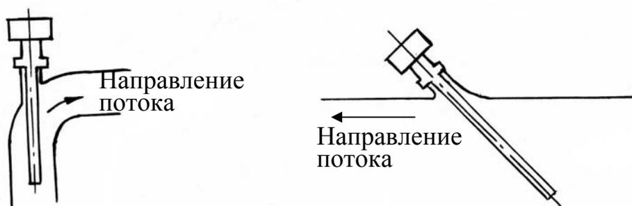
Рис. 3. Установка ТУДЭ-М1 на трубопроводе:
